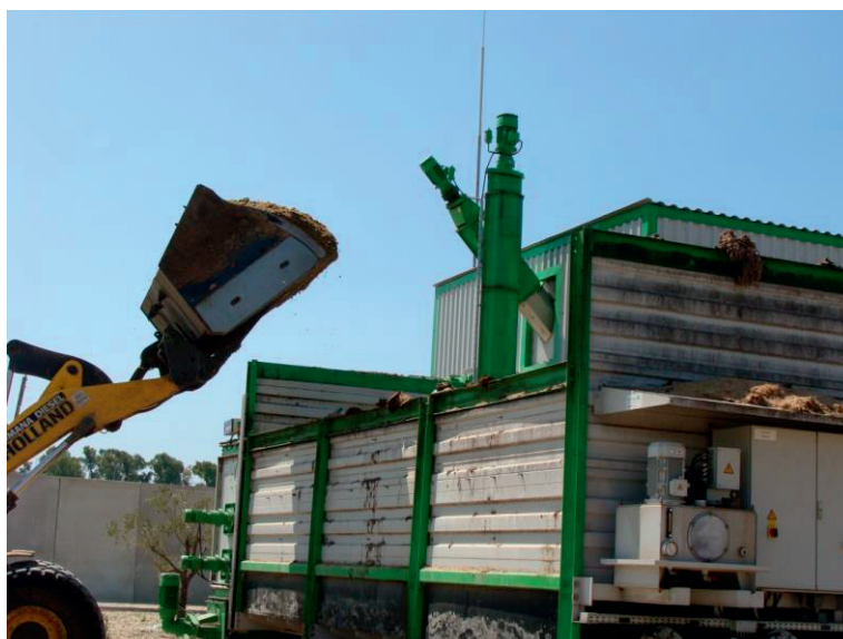
Figura 3 - La tramoggia di carico dell'insilato
