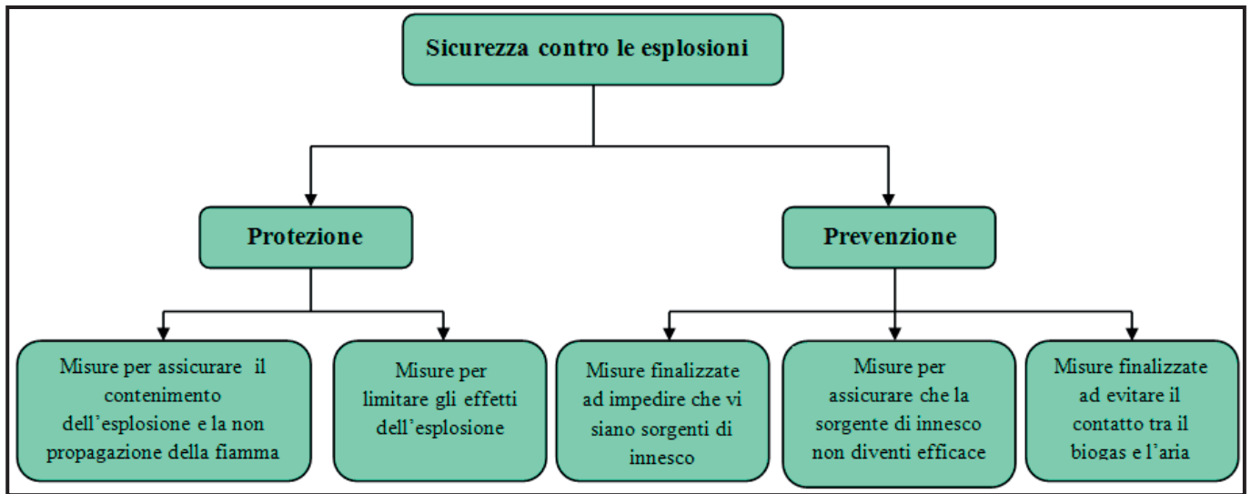
Figura 13 - Misure di prevenzione e di protezione contro il rischio esplosione
