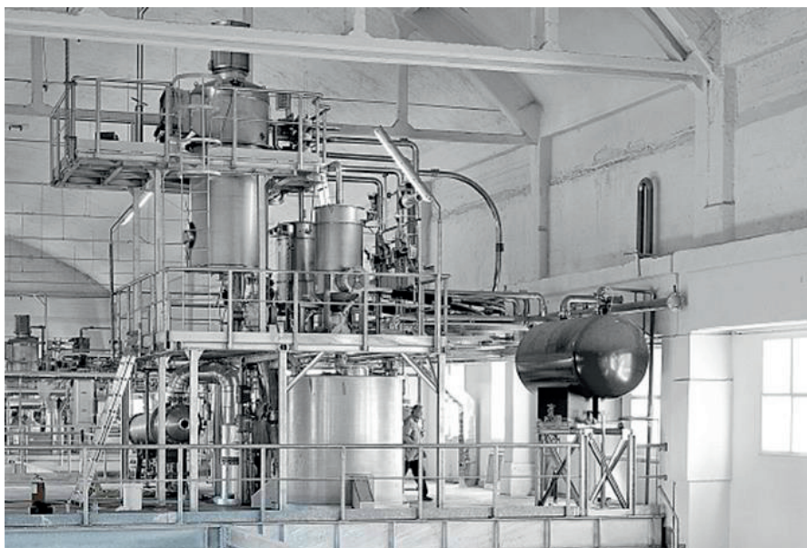
Figura 6 - Impianto di alimentazione dei monomeri per la produzione di polimeri biodegradabili
