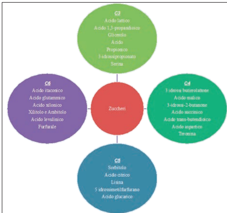
Figura 2 - Prodotti chimici ad alto valore aggiunto ottenuti dalla fermentazione di zuccheri a 3, 4, 5, 6 atomi di carbonio che possono utilizzati ulteriormente come precursori di altri prodotti chimici di rilevanza economica
